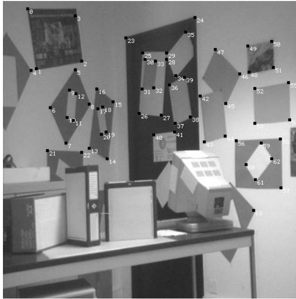
Σχήμα 4.2: Σημεία των επιπέδων της τρίτης εικόνας, των οποίων γνωρίζουμε τις αντιστοιχίσεις με αυτά του στερεοσκοπικού ζεύγους
