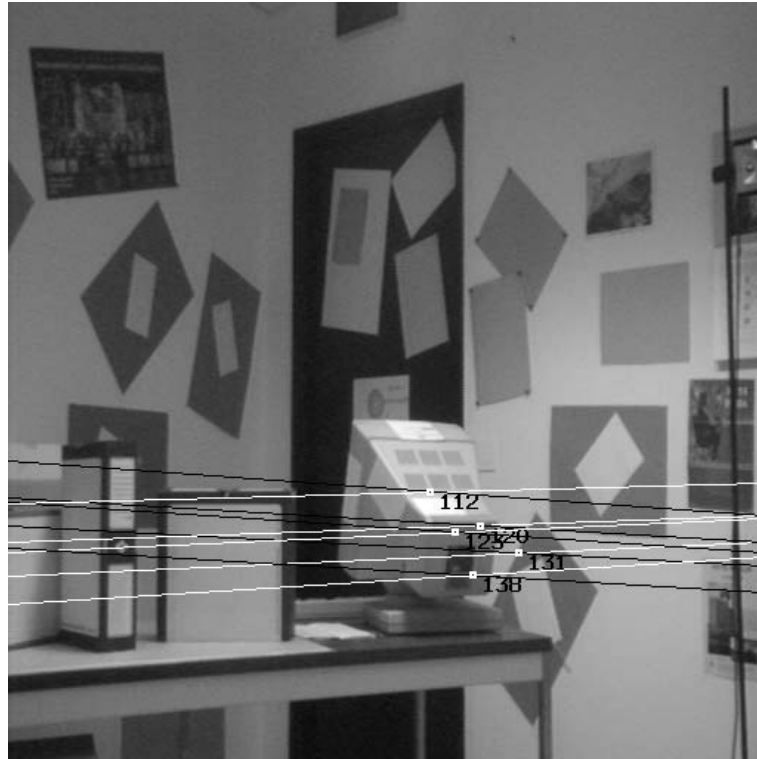
Σχήμα 5.18: Προβολή σημείων στην τρίτη εικόνα μέσω επιπολικών περιορισμών, υπολογισμένων από προβολικότητες.
