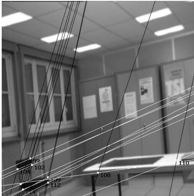
Σχήμα 5.27: Προβολή σημείων μέσω επιπολικών περιορισμών υπολογισμένων από προβολικότητες
