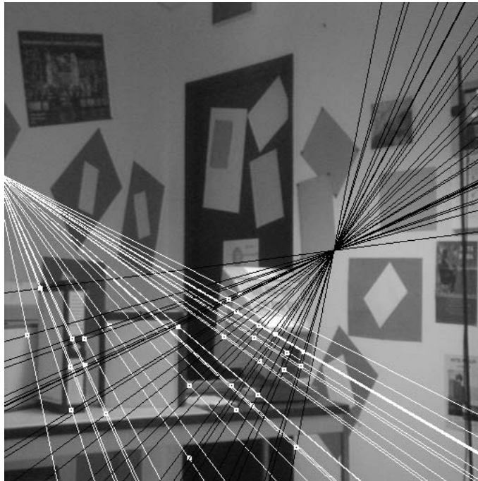
Σχήμα 5.20: Προβολή σημείων στην τρίτη εικόνα μέσω επιπολικών περιορισμών υπολογισμένων από σημεία των δύο επιπέδων
