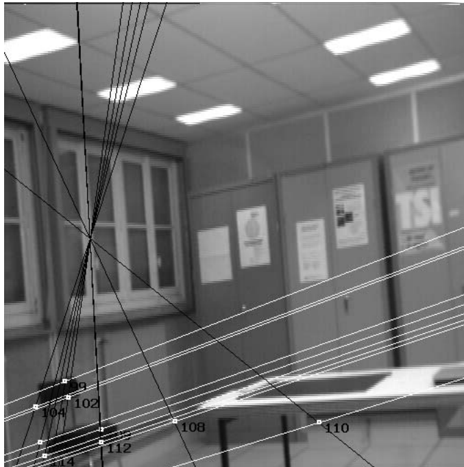
Σχήμα 5.24: Προβολή σημείων στην τρίτη εικόνα μέσω περιορισμών υπολογισμένων από τους Θεμελιώδη πίνακα.
