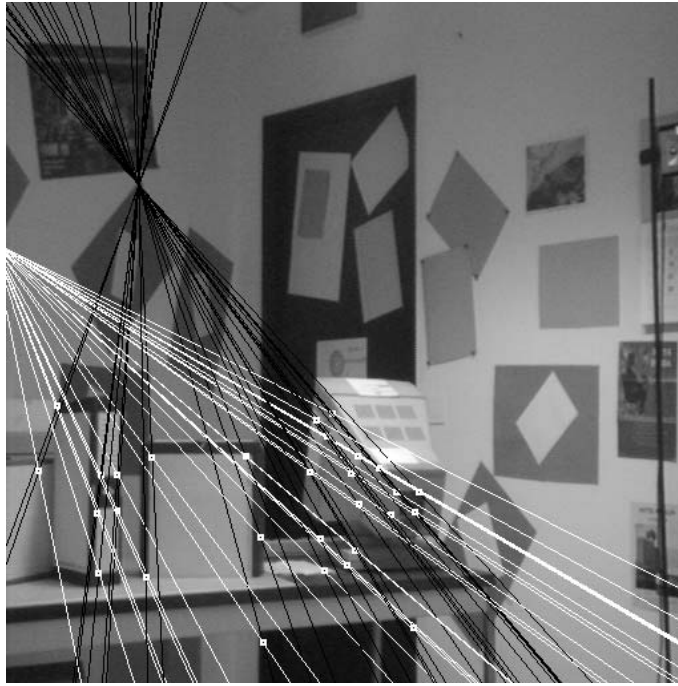
Σχήμα 5.19: Προβολή σημείων στην τρίτη εικόνα μέσω περιορισμών υπολογισμένων από σημεία του ενός επιπέδου.
