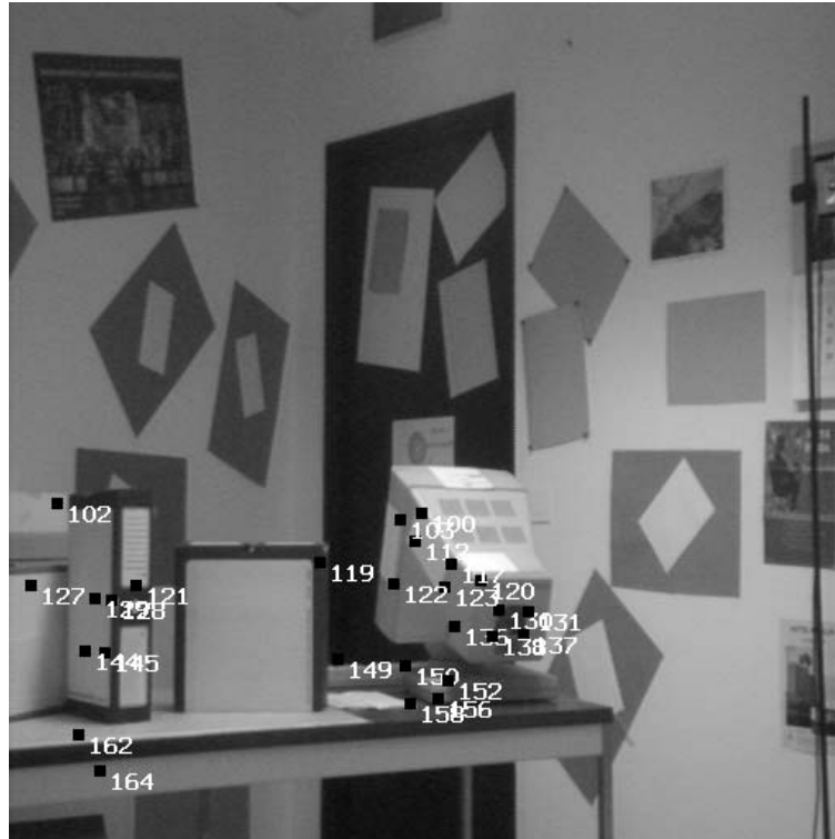
Σχήμα 5.16: Προβολή σημείων στην τρίτη εικόνα με χρήση προβολικού βάθους.
