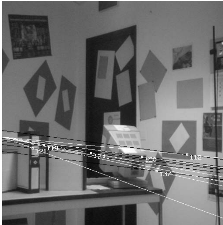
Σχήμα 5.15: Προβολή σημείων στην τρίτη εικόνα με χρήση θεμελιώδη πίνακα.
