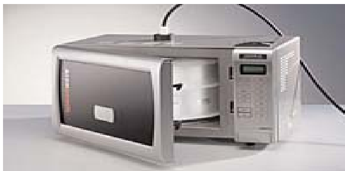
Εικόνα 3.2. Συσκευή όξινης χώνευσης με την χρήση ακτινοβολίας μικροκυμάτων.
