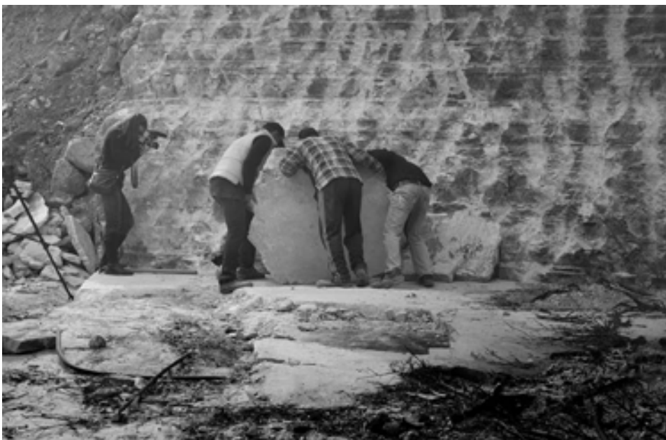
Φωτ. 1-2. Εξόρυξη ακονόπετρας με χρήση φωτιάς. Μάρτιος 2009.
