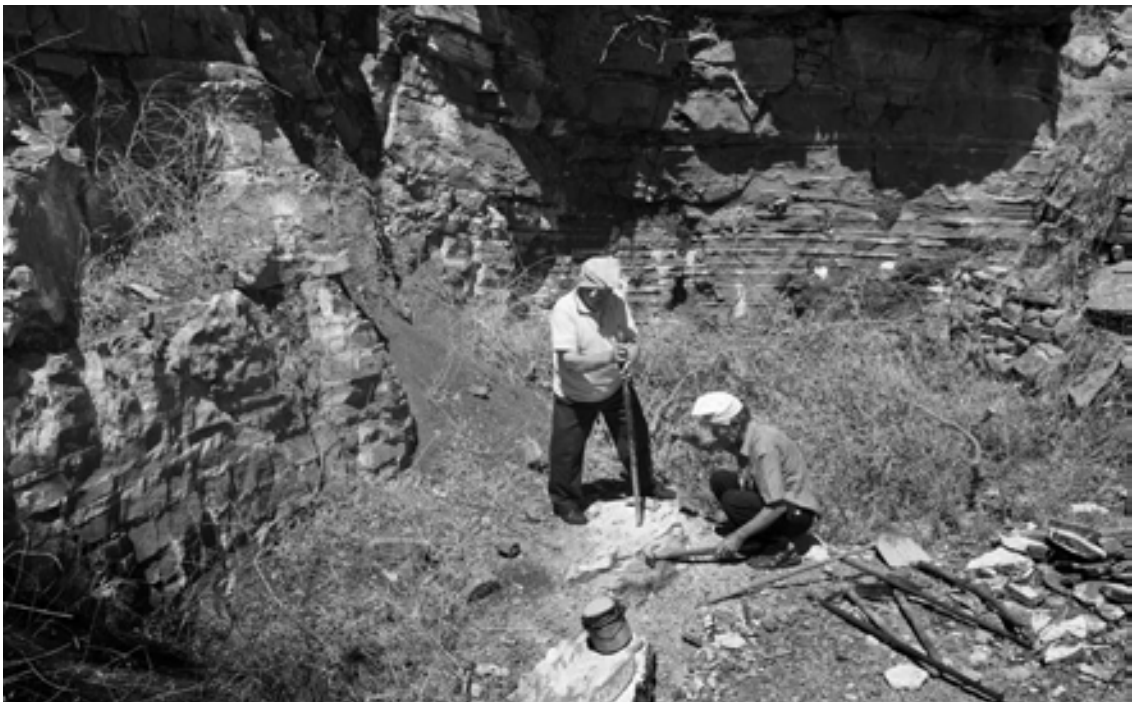
Φωτ. 4. Εξόρυξη ακόνης με προβιομηχανικές τεχνικές χωρίς χρήση φωτιάς. Ιούλιος 2006.
