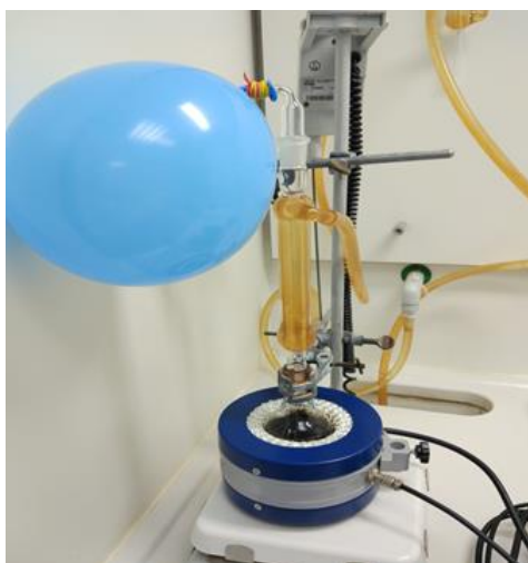
Σ-5.1.3.1: Φωτογραφία πειραματικής διάταξης κατά την διάρκεια του reflux. Η σφαιρική φιάλη είναι τοποθετημένη στον μανδύα για την επίτευξη ομοιόμορφης θερμοκρασίας. Έχει εφαρμοστεί ψυκτήρας και μπαλόني αζώτου για αδρανείς συνθήκες. Το υλικό έχει αποκτήσει ένα μπορντό χρώμα.
