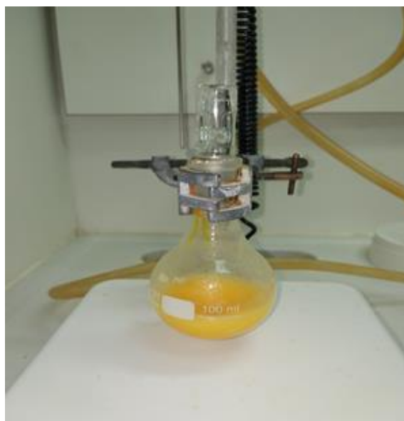
Σ-5.1.1.1: Φωτογραφία του διαλύματος πριν το reflux. Το μίγμα της όρθο-φαινυλενοδιαμίνης, του δίχλωρομεθανίου και της τριαιθυλαμίνης έχει αποκτήσει ένα πυκνό κίτρινο χρώμα.
