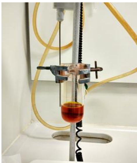
Σ-5.1.3.3: Φωτογραφία μετά το πέρας της φυγοκέντρησης. Στον πάτο του φυγοκεντρικού σωλήνα έχει καθιζάνει το στερεό.
