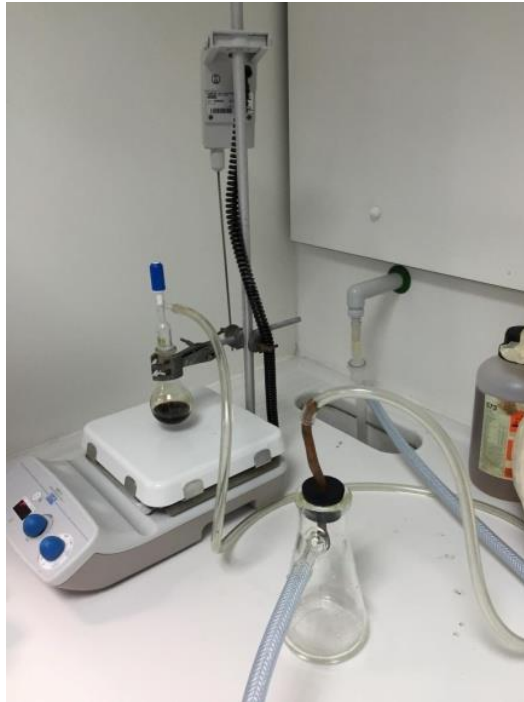
Σ-5.2.3.1: Φωτογραφία από την διαδικασία συμπύκνωσης του διαλύματος με την βοήθεια αντλίας κενού και χρήση παγίδας.
