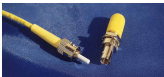
Σχ.2.11. ST Connector και Adaptor
