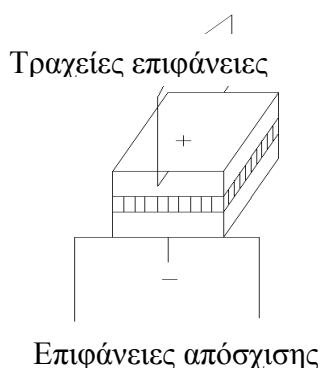
Σχ.3.4. Διάγραμμα laser επαφής p-n.
