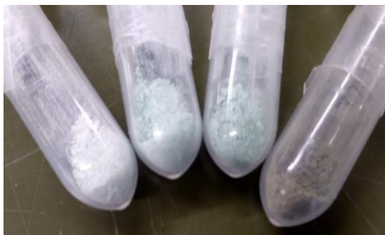
Εικόνα 3.22: Από αριστερά προς τα δεξιά φαίνονται τα τελικά ιζήματα των 0.1% Co-ZnO, 0.5% Co-ZnO, 1% Co-ZnO και 10% Co-ZnO.
