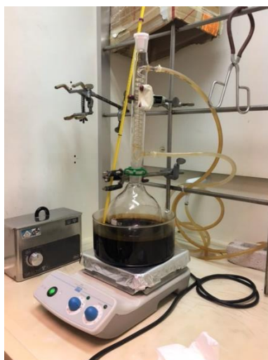
Εικόνα 2.1: Διάταξη για τη μέθοδο reflux. Ένας ψυκτήρας επαναροής έχει τοποθετηθεί στη φιάλη ώστε οι ατμοί που δημιουργούνται κατά τη διάρκεια της αντίδρασης ψύχονται, υγροποιούνται και επανέρχονται στο μίγμα της αντίδρασης.
