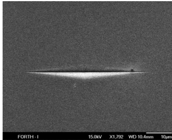
Σχήμα 6.3: Εικόνα SEM αποτυπώματος Κνοορ σε γυαλί IOG-1
