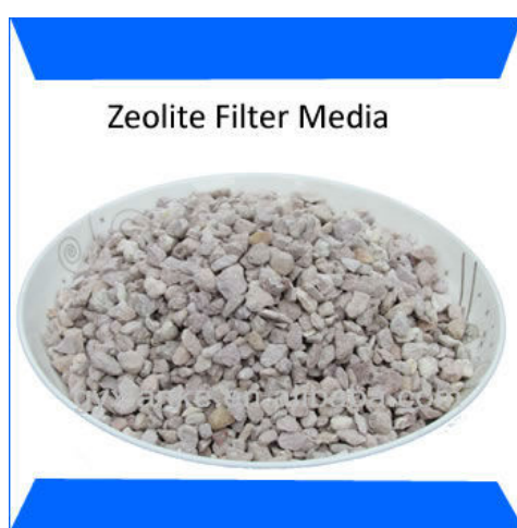
ΣΧΗΜΑ 1.1: Τυπική μορφή εμπορικού ζεόλιθου που βρίσκει χρήση ως μέσο φιλτραρίσματος πόσιμου νερού.
