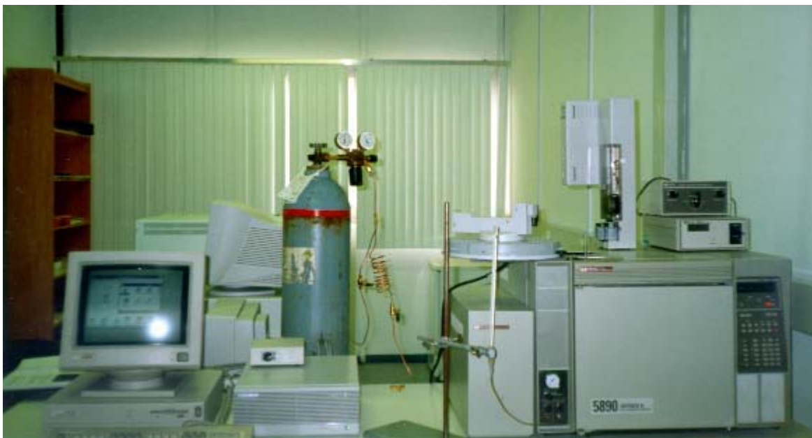
Εικόνα 6.2 Αέριος χρωματογράφος (GC) με ανιχνευτή φασματογράφο μάζας με τετραπολικό φίλτρο (MS)
