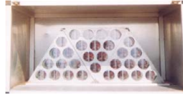
Εικόνα 3.13: Ανακλαστικοί καθρέπτες (απόσταση 5.2km)
