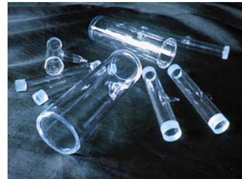
Εικόνα 3.24: Κυψελίδες πρότυπων αερίων – πχ \text{NO}_2
