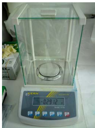
Σχήμα 11.2 : Εργαστηριακός ζυγός ακριβείας (ελάχιστο βάρος ζύγισης 0,0001 gr).
