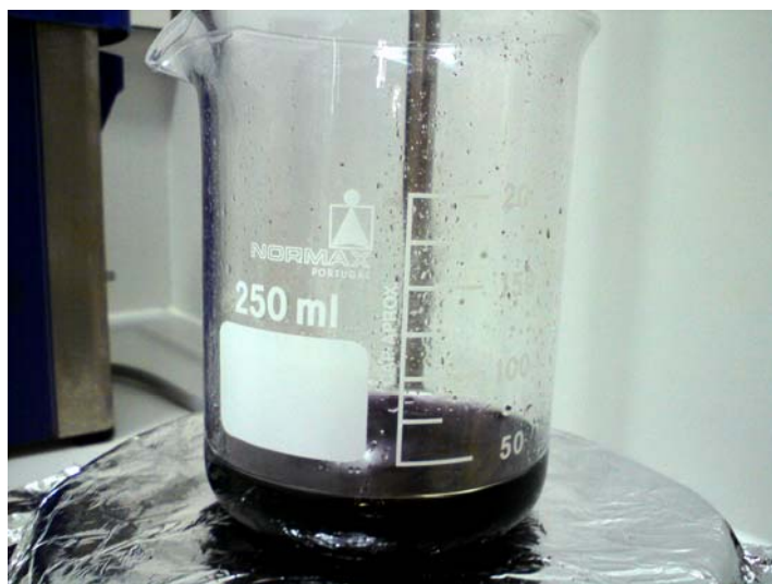
Σχήμα 9.3: Παρασκευή ZnO με τη μέθοδο citrate gel.
