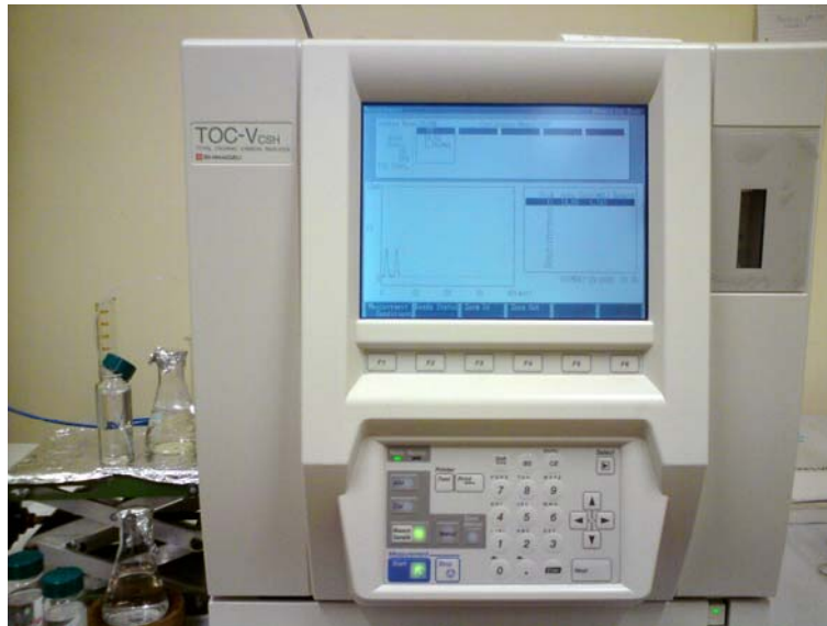
Σχήμα 11.11 : Συσκευή μέτρησης ολικού οργανικού άνθρακα.
