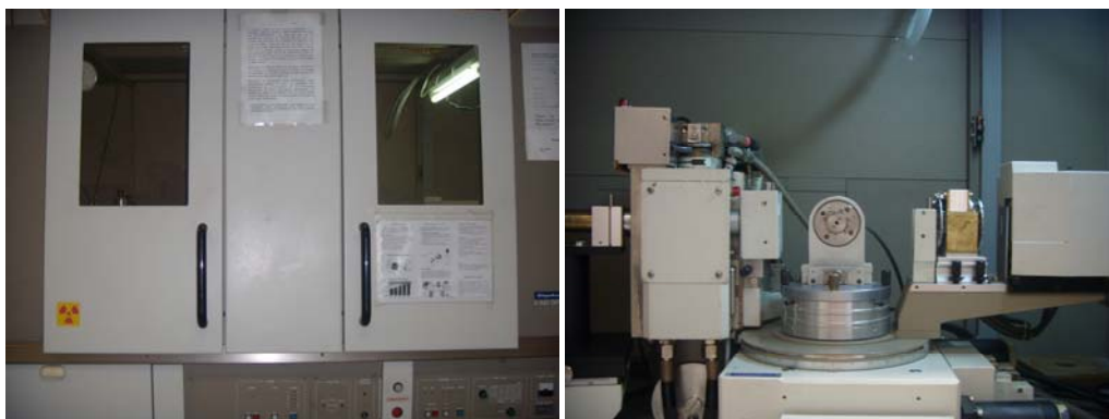
Σχήμα 10.1: Περιθλασίμετρο ακτίνων Χ Rigaku (RINT 2000).
