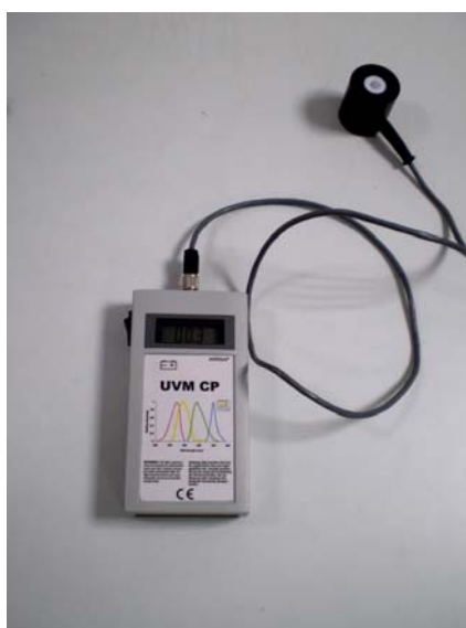
Σχήμα 11.7 : Ραδιόμετρο UV-meter UVM CP.
