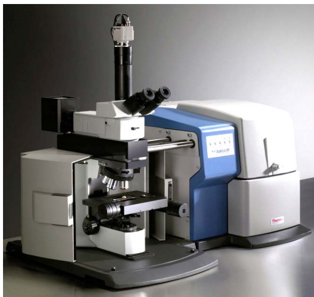
Σχήμα 10.3 : Φασματόμετρο Raman, Nicolet Almega XR.
