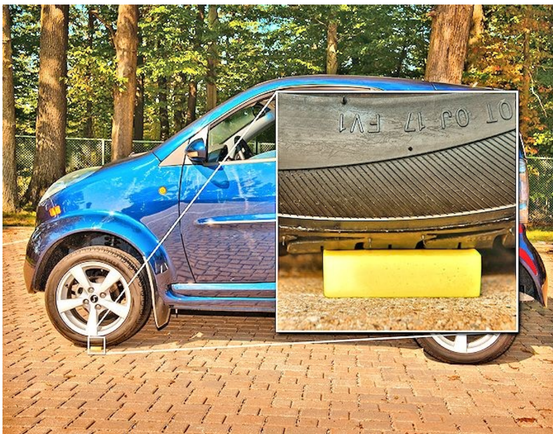
Εικόνα 2.2: Αυτοκίνητο στηρίζεται σε ένα κομμάτι αεροπηκτικής (Meador, 2008).
