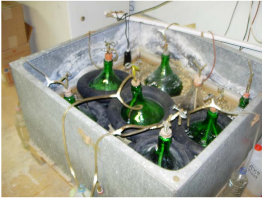
Φωτογραφία 4.1: Πειραματική διάταξη εγκλιματισμού των αναερόβιων καλλιέργειών
