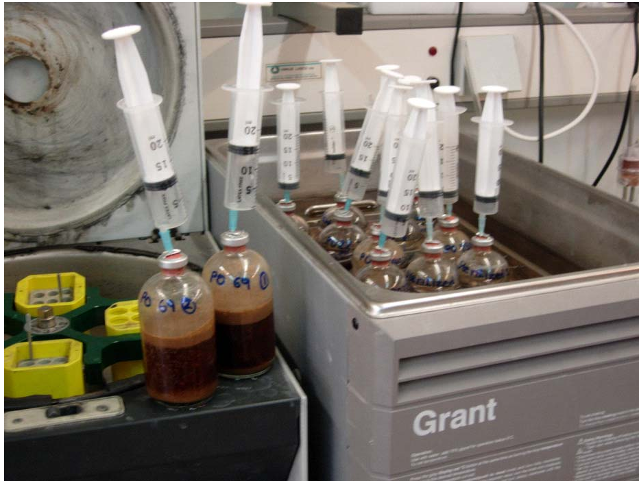
Φωτογραφία 2.1: Πειραματική διάταξη της επώασης των αντιδραστών διαλείποντος έργου
