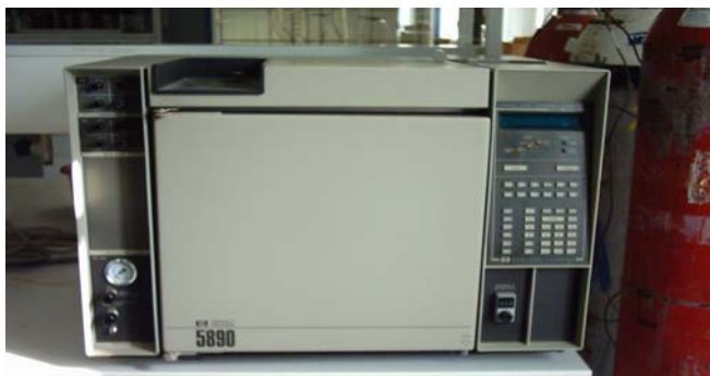
Σχήμα 6.3. Αέριος χρωματογράφος με ανιχνευτή ιονισμού φλόγας (GC-FID)
