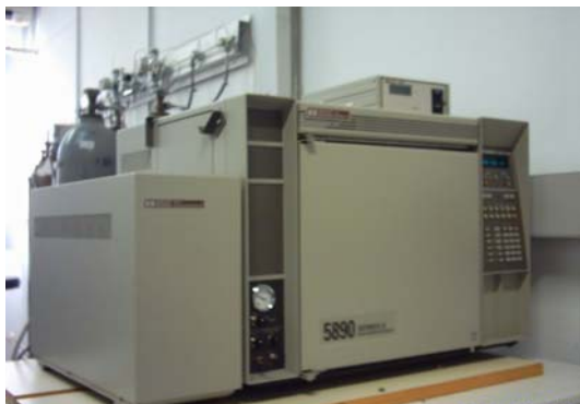
Σχήμα 6.4. Αέριος χρωματογράφος με ανιχνευτή Φασματογράφο μάζας (GC-MS)
