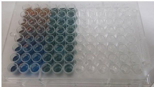
Εικόνα 12: Απεικόνιση μικροπλάκας για την μέθοδο Bradford, ένα στάδιο πριν την διαδικασία φωτομέτρησης
