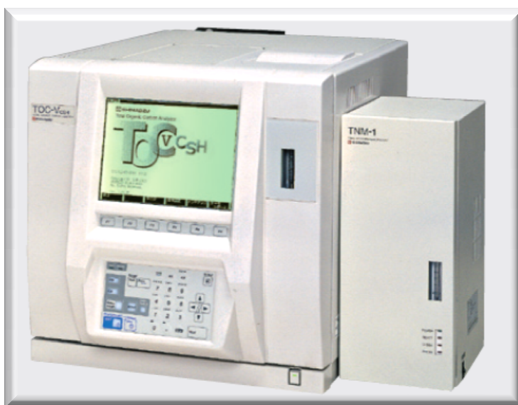
Εικόνα 3.9: Αναλυτής TOC-V CSH συζευγμένος με μονάδα μέτρησης ολικού αζώτου TNM-1 (Shimadzu)
