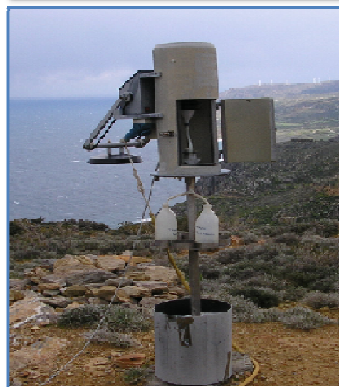
Εικόνα 2.3: Δειγματολήπτης Van Essen στον ερευνητικό σταθμό της Φινοκαλιάς.
