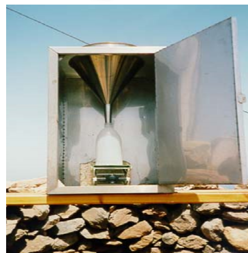
Εικόνα 2.4: Συλλέκτης ξηρής εναπόθεσης στον ερευνητικό σταθμό της Φινοκαλιάς
