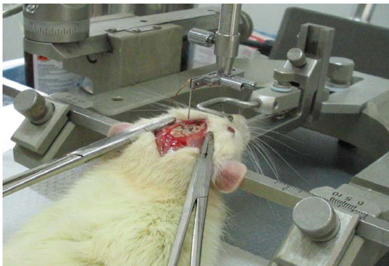
ΕΙΚΟΝΑ-2: Επίμυς ο οποίος έχει τοποθετηθεί σε στερεοταξική συσκευή. Διακρίνεται ο προς εμφύτευση οδηγός σωλήνας που είναι τοποθετημένος σε ειδική υποδοχή, προσαρμοσμένη σε βραχίονα μετρονομημένο σε χιλιοστόμετρα με κλίμακα βερνιέρου
