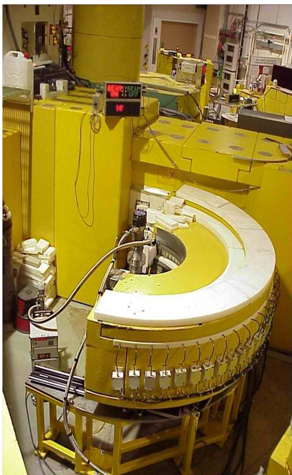
Σχήμα Π.Α.30. Παρουσιάζεται η πειραματική διάταξη του περιθλασίμετρο BT1 / NIST στο εργαστήριο σε πραγματικές συνθήκες. Διακρίνεται η τοξοειδής διάταξη των ανιχνευτών και των κατευθυντήρων. Αυτοί οι 32 ανιχνευτές μπορούν να χρησιμοποιηθούν συνδυαστικά με τρεις διαφορετικούς μονοχρωμάτορες –το Ge(311), το Cu(311) ή το μονοχρωμάτορα Ge(733)– και δυο κατευθυντήρες –διαστάσεων 7' ή 15' –, ανάλογα με τις ανάγκες της εκάστοτε μέτρησης.
