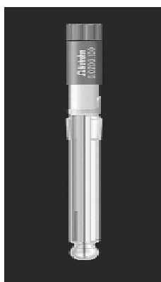
Σχήμα 8: Συνδυαστικό εκλεκτικό ηλεκτρόδιο υάλου-καλομέλανος
