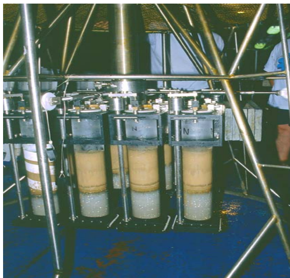
Εικόνα 5. Α) Το υποβρύχιο Alvin, Β) Ο πολλαπλός πυρηνολήπτης Bowers & Connolly
