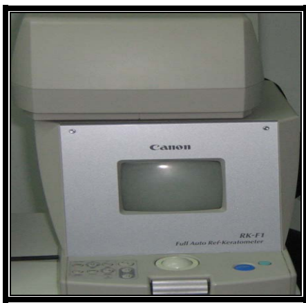
Εικόνα 16. Canon RK – F1 Full Auto Ref – keratometer, το οποίο χρησιμοποιήθηκε για την μέτρηση των καμπυλοτήτων των εξεταζόμενων.
