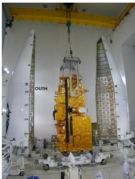
Εικόνα 3.12: Ο TERRA τοποθετείται στον πύραυλο ( http://www.acd.ucar.edu/mopitt/MOPITT/instr/index.html )
