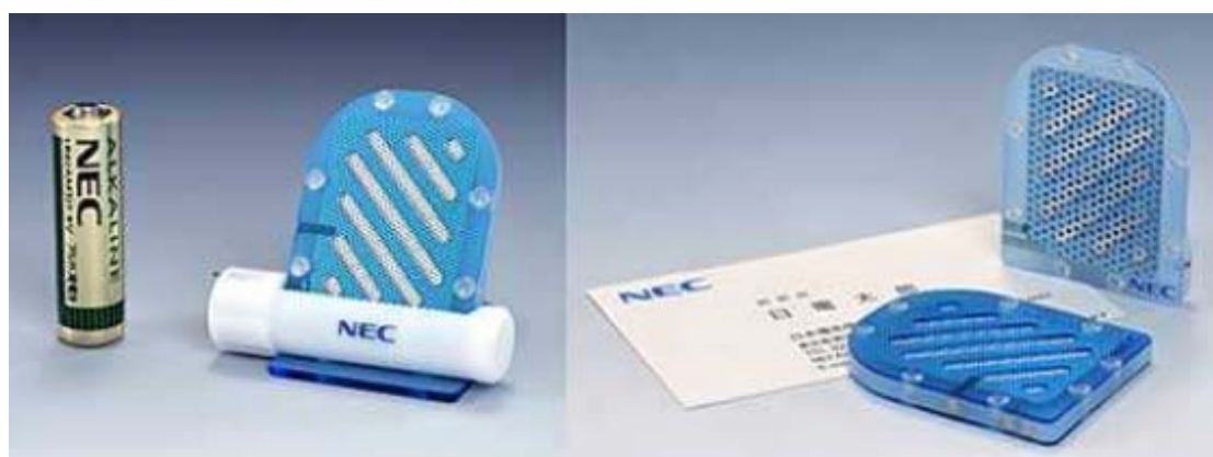
Σχήμα 1.5.6. Μπαταρία κινητού τηλεφώνου που χρησιμοποιεί CNHs ως ηλεκτρόδια.
