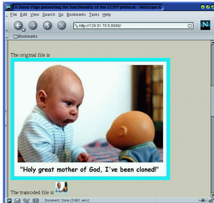
Εικόνα 12 Αποτέλεσμα του transcoding σε μια GIF εικόνα. Η μετατροπή της σε μικρότερο μέγεθος
