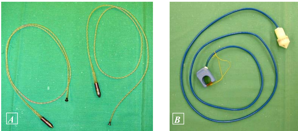
Εικόνα 2-6 A: Ανιχνευτές πίεσης τύπου Konigsberg.
