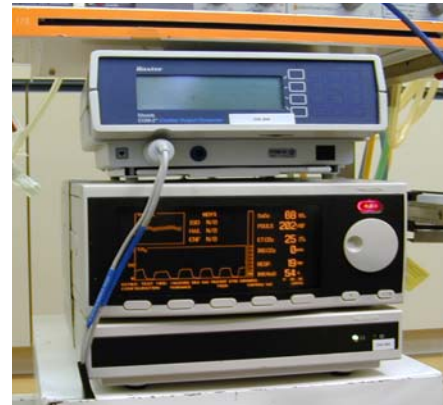
Εικόνα 2-3: Παλμικό οξύμετρο Nellcor N2500 (πάνω) και monitor συνεχούς παρακολούθησης αναπνευστικών αερίων Datex Ultima (κάτω).
