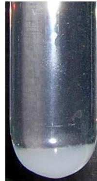
Εικόνα 3.18 : Εμφάνιση ιζήματος SiO 2 παρουσία 100ppm MgSO 4 ·7H 2 O και 100ppm EDTA σε pH=9,5
