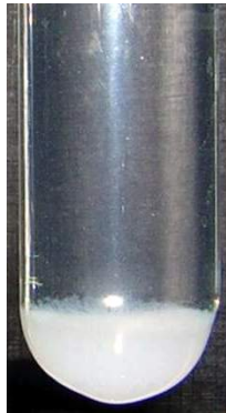
Εικόνα 3.17 : Εμφάνιση ιζήματος SiO 2 παρουσία 100ppm MgSO 4 ·7H 2 O σε pH=9,5
