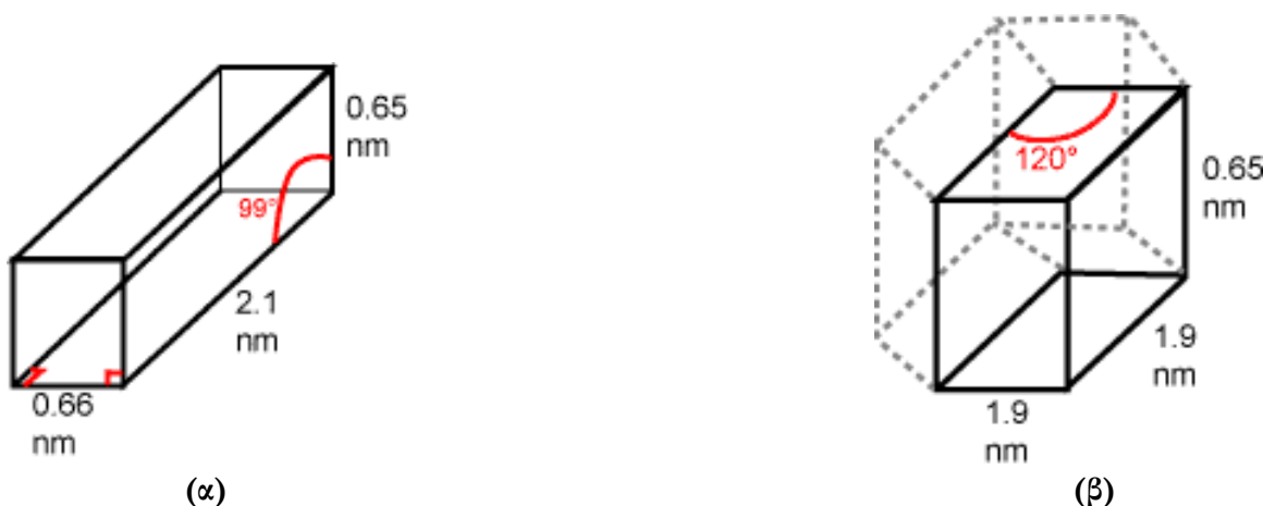
Εικόνα 3.20: Μοναδιαία κυψελίδα (α) πολυπροπυλενίου α-φάσης, (β) πολυπροπυλενίου β-φάσης (10) .
