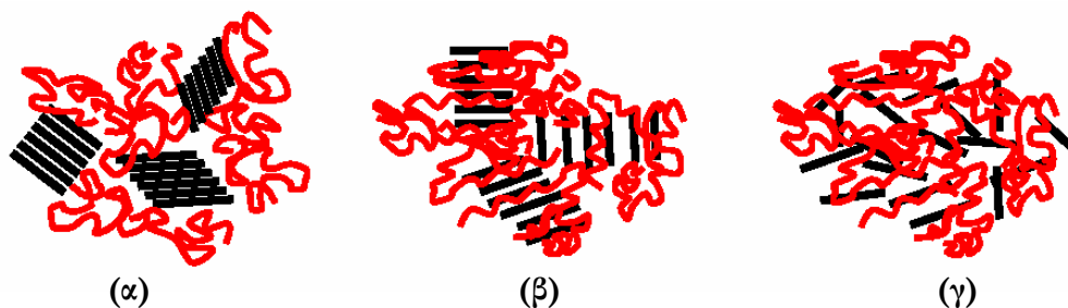
Εικόνα 1.4 : Σχηματική αναπαράσταση των διαφορετικών δομών νανοσύνθετων υλικών πολυμερών/ πολυστρωματικών πυριτιούχων πηλών, (α) φασικά διαχωρισμένη, δομή, (β) δομή παρεμβολής και (γ) διεσπαρμένη δομή
