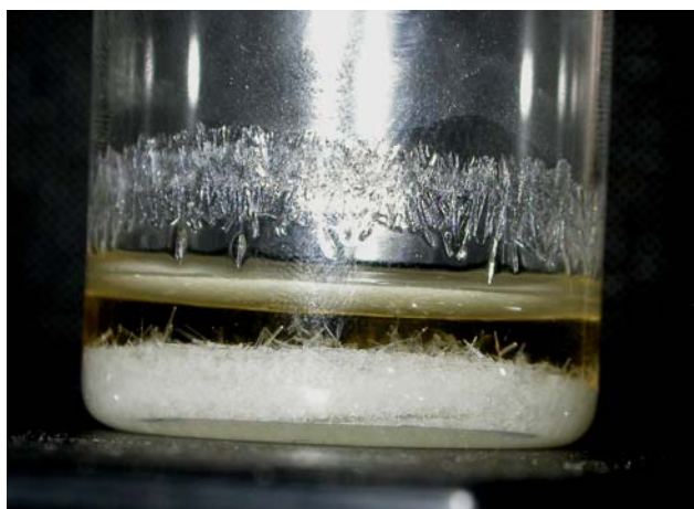
Εικόνα 4.22 : Μορφή περοβσκιτή κατά την έξοδό του απο τον φούρνο.
