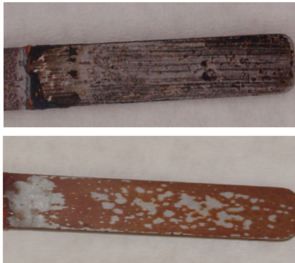
Εικόνα 4.5 Αντιδιαβρωτική δράση του Mg –BABBMP σε επιφάνεια χάλυβα. Το πρώτο δοκίμιο (επάνω) είναι το control (απουσία παρεμποδιστή) ενώ στο δεύτερο (κάτω) βλέπουμε το προστατευτικό υμένιο του Mg –BABBMP.
