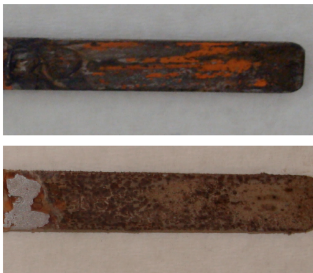
Εικόνα 4.7 Αντιδιαβρωτική δράση του Mg –BABBMP σε pH 5,0 σε επιφάνεια χάλυβα. Το πρώτο δοκίμιο (επάνω) είναι το control (απουσία παρεμποδιστή) ενώ στο δεύτερο (κάτω) φαίνεται το προστατευτικό υμένιο του Mg –BABBMP.
