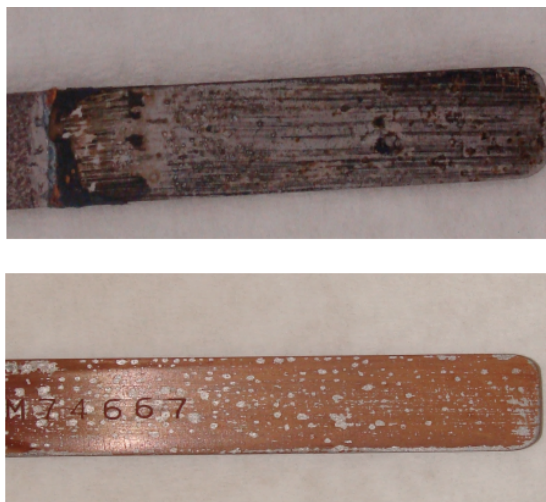
Εικόνα 4.3 Η αντιδιαβρωτική δράση του υλικού Zn –BABBMP σε χάλυβα σε pH 2.5. Η πρώτη εικόνα αντιστοιχεί στο “control” (απουσία προσθέτου), ενώ το δεύτερο είναι το δοκίμιο χάλυβα στο οποίο παρατηρούμε το προστατευτικό film στην επιφάνεια του.
