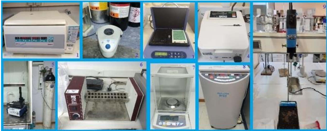
Σχήμα 3.3: 1)Φυγόκεντρος, 2)Vortex, 3)Σύστημα επώασης Elisa kit, 4)Φυγόκεντρος για Eppendorf, 5)Σύστημα εξάτμισης, 6)Σύστημα εκχύλισης, 7)Αναλυτικός ζυγός, 8)Φυγόκεντρος ισχυρής έντασης, 9)Ομογενοποιητής δειγμάτων
