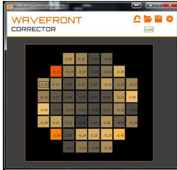
Εικόνα 33: Παράθυρο παρατήρησης των ενεργοποιητών του προσαρμοστικού καθρέφτη κατά τη διάρκεια του πειράματος.
