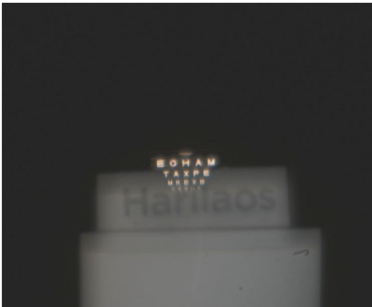
Εικόνα 43: Ποιότητα εικόνας διπλοεστιακού φακού όπως παρατηρήθηκε από τον τεχνητό οφθαλμό μέσα από το σύστημα προσαρμοστικών οπτικών.
