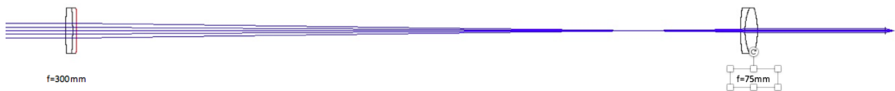
Εικόνα 24: Σχηματική απεικόνιση του δεύτερου τηλεσκοπίου. Στο αριστερό μέρος της εικόνας βρίσκεται ο φακός εστιακής απόστασης 300 mm έπειτα ακολουθεί ο φακός εστιακής απόστασης 75mm και τέλος έχει τοποθετηθεί μια επιφάνεια ώστε να υπάρχει αντιστοιχία με την επιφάνεια του ανιχνευτή. Η εικόνα αυτή προήλθε από το πρόγραμμα Zemax.
