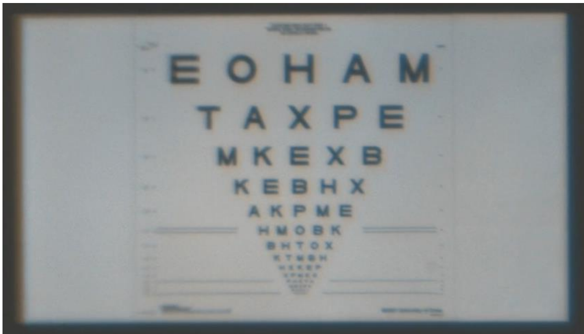
Εικόνα 38: : Εικόνα που λάμβανε ο τεχνητός οφθαλμός τοποθετημένος στη θέση εξέτασης μετά τη διόρθωση.
