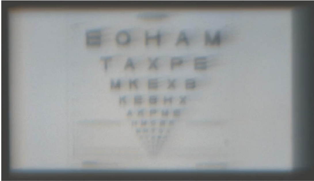
Εικόνα 37: Εικόνα που λάμβανε ο τεχνητός οφθαλμός τοποθετημένος στη θέση εξέτασης πριν τη διόρθωση.
