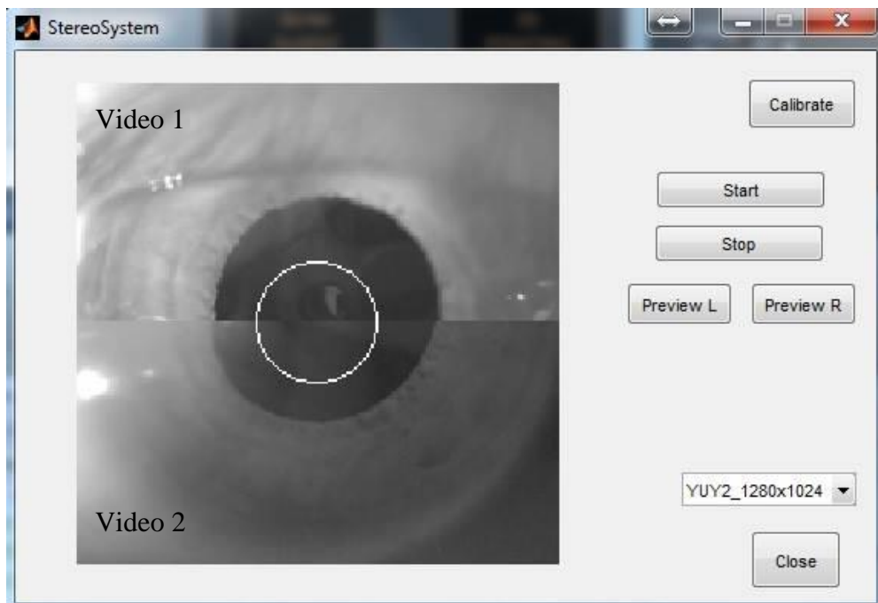
Εικόνα 26: Εικόνα παρατήρησης του οφθαλμού μέσω του προγράμματος που αναπτύχθηκε στο Matlab για την παρακολούθηση και ευθυγράμμιση του οφθαλμού με τα υπόλοιπα οπτικά στοιχεία.
