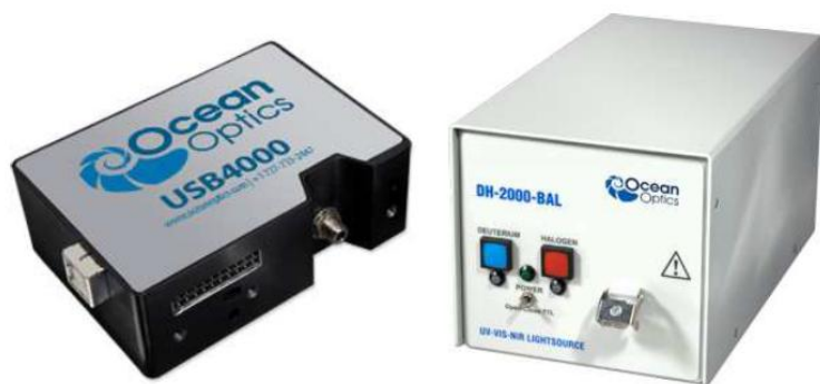
Εικόνα 26. Το φωτόμετρο τύπου Ocean Optics USB4000 εξοπλισμένο με τη φωτεινή πηγή τύπου DH-2000-BAL.
