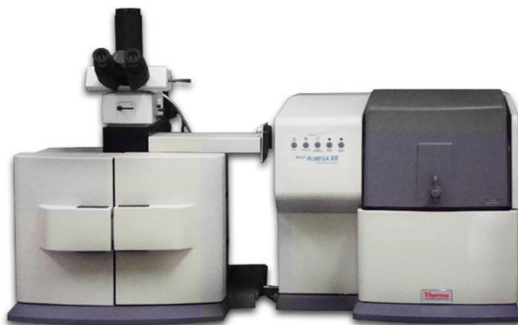
Εικόνα 32. Το Nicolet Almega XR Raman φωτόμετρο εξοπλισμένο με ένα 473nm μπλε λέιζερ.
