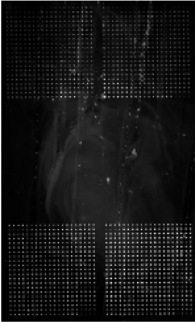
Εικόνα 16 Η τελική μικροσυστοιχία. Τα spots έχουν βαφεί με Sybr Green και σκαναριστεί στα 488nm
