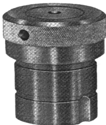
Σχήμα 2.1 Εξωτερικό μέρος, Parr αντιδραστήρα (acid digestion bomb) όγκου 23 ml.
