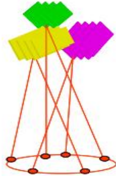
Εικόνα 4.8: Σχηματισμός εικόνας περίθλασης ηλεκτρονίων από πολυκρυσταλλικό υλικό.
