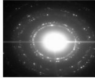
Εικόνα 4.8: Σχηματισμός εικόνας περίθλασης ηλεκτρονίων από πολυκρυσταλλικό υλικό.
