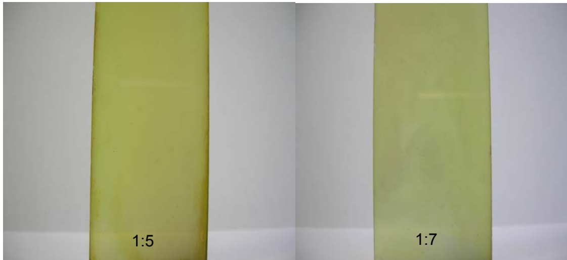
Φωτογραφίες 3.2: Σταθερή θερμοκρασία 450°C, αναλογίες 1:5, 1:7, χρόνος εναπόθεσης 2 min.
