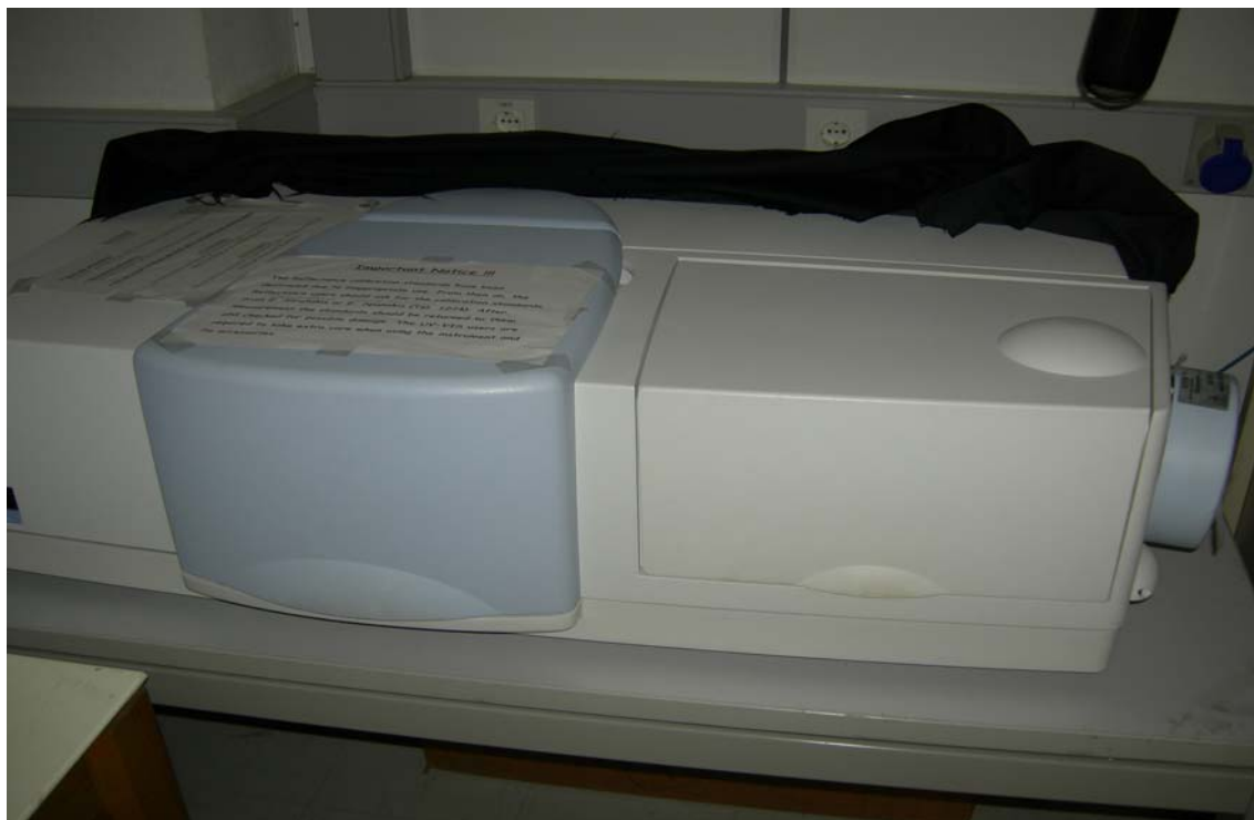
Εικόνα 4.1: Φασματοφωτόμετρο Perkin Elmer Lambda 950.
