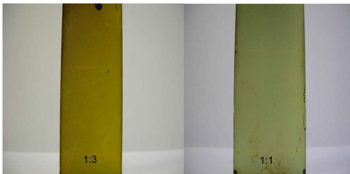
Φωτογραφίες 3.1: Σταθερή θερμοκρασία 450^{\circ}\text{C} , αναλογίες 1:1, 1:3, χρόνος εναπόθεσης 2 min.
