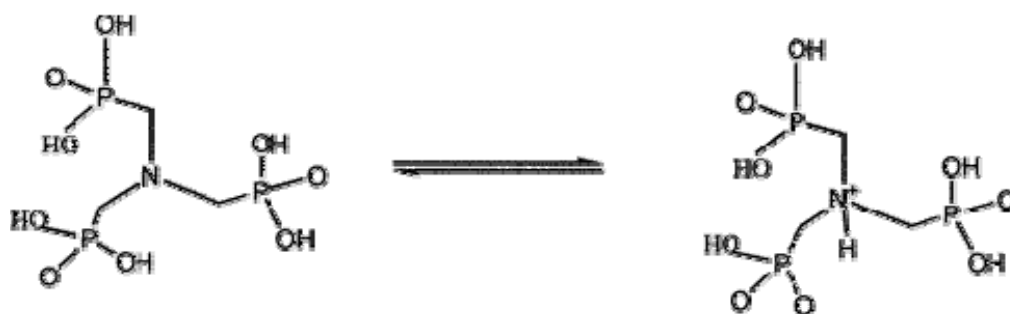
Σχήμα 6: Η δομή του AMP σε ελεύθερη, μη συναρμοσμένη με μέταλλο μορφή.
