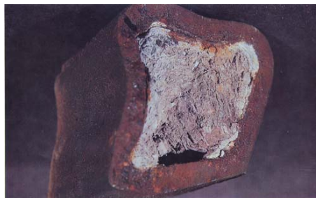
Σχήμα 2: Εναπόθεση δυσδιάλυτων αλάτων σε επιφάνειες ανταλλαγής θερμότητας.
