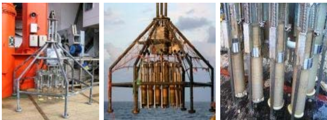
Εικόνα 2.2: Πολυπυρηνοδειγματολήπτης τύπου Bowers/Conelly (Multi-corer).
