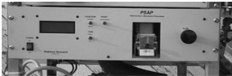
Εικόνα 3-12: Φωτόμετρο απορρόφησης: Particle Soot Absorption Photometer (PSAP).
