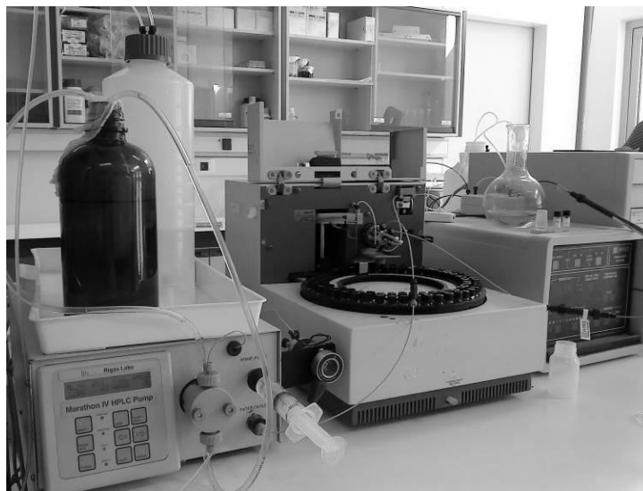
Εικόνα 3-9: Ιοντική χρωματογραφία για τον προσδιορισμό των κατιόντων.
