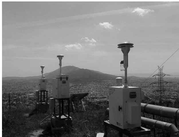
Εικόνα 3-2: Οι δειγματολήπτες Dichotomous Partisol (R&P Co) και Partisol FRM Models 2000 (R&P Co) στον περιαστικό σταθμό της Πεντέλης.
