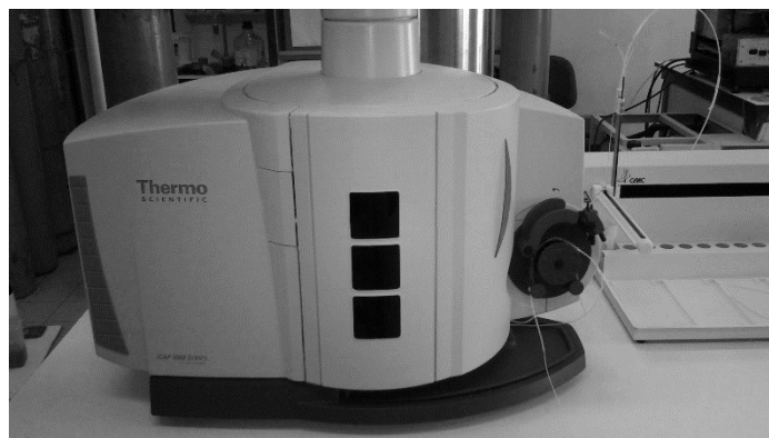
Εικόνα 3-10: Φασματόμετρο οπτικής εκπομπής επαγωγικά συζευγμένου πλάσματος– (ICP-OES), για τον προσδιορισμό των μετάλλων.
