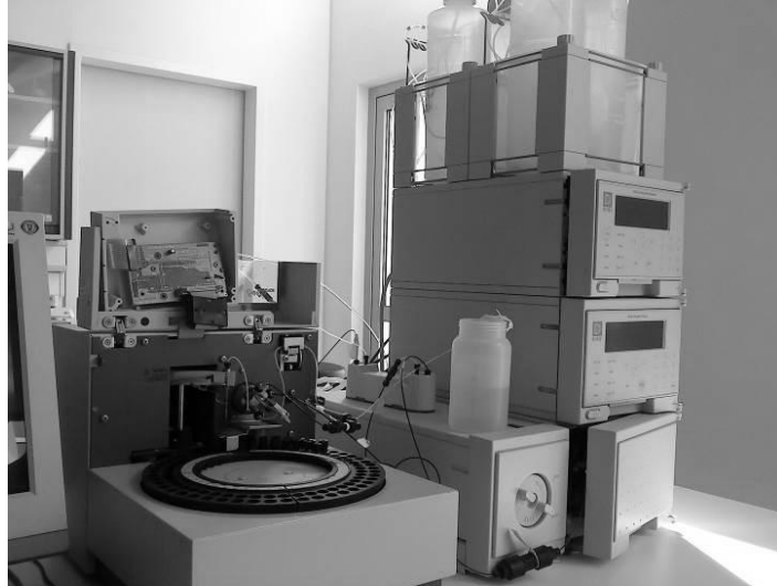
Εικόνα 3-8: Ιοντική χρωματογραφία για τον προσδιορισμό των ανιόντων.
