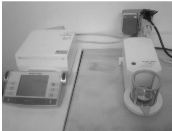
Εικόνα 3-5: Ο ζυγός Mettler Toledo MX5.
