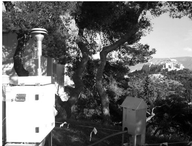
Εικόνα 3-3: Ο δειγματολήπτης Dichotomous Partisol (R&P Co) στον αστικό σταθμό υποβάθρου του Θησείου.
