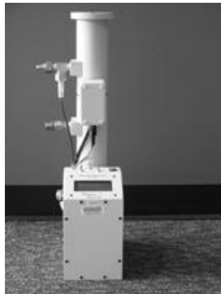
Εικόνα 3-11: Νεφελόμετρο Radiance Research Model 903.
