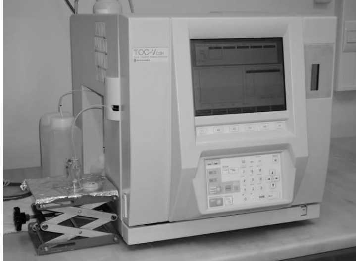
Εικόνα 3-7: Αναλυτής ολικού οργανικού άνθρακα.
