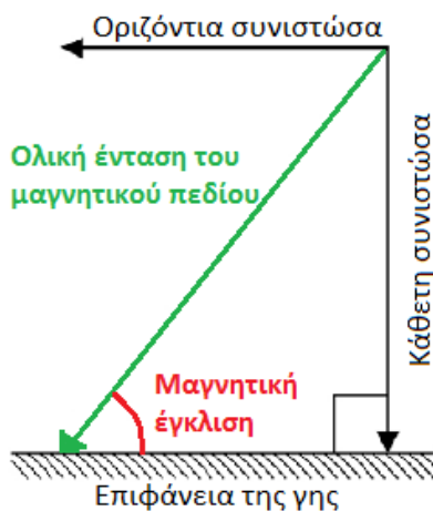
Εικ. 2. Διάγραμμα στο οποίο απεικονίζονται τα διανυσματικά μεγέθη τεσσάρων γεωμαγνητικών στοιχείων τα οποία παρέχουν πληροφορίες θέσεως σε ζώα με μαγνητική αντίληψη. Το μαγνητικό πεδίο κάθε σημείου πάνω στη Γη μπορεί να περιγραφεί με όρους μαγνητική έγκλισης και ολικής έντασης του. Η ολική ένταση του μαγνητικού πεδίου αναλύεται σε δύο διανυσματικούς παραμέτρους: τη συνολική οριζόντια συνιστώσα και τη συνολική κάθετη συνιστώσα.
