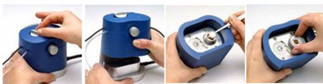
Εικ. 3.6. A) Το σύστημα Q-Sense D300. B) Συσκευές ακουστικού βιοαισθητήρα QCM-D. (Πηγή: www.q-sense.com )
