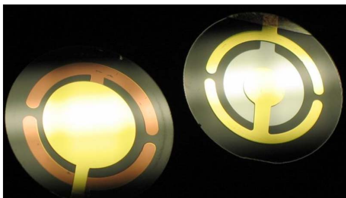
Εικ. 2.8. Συσκευή ακουστικού βιοαισθητήρα QCM. (Πηγή: www.wikipedia.org )
