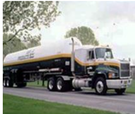
Εικόνα 1.5 Μεταφορά υδρογόνου με κρυογενικό βυτιοφόρο (πηγή: U.S. Department of Energy Hydrogen Program)
