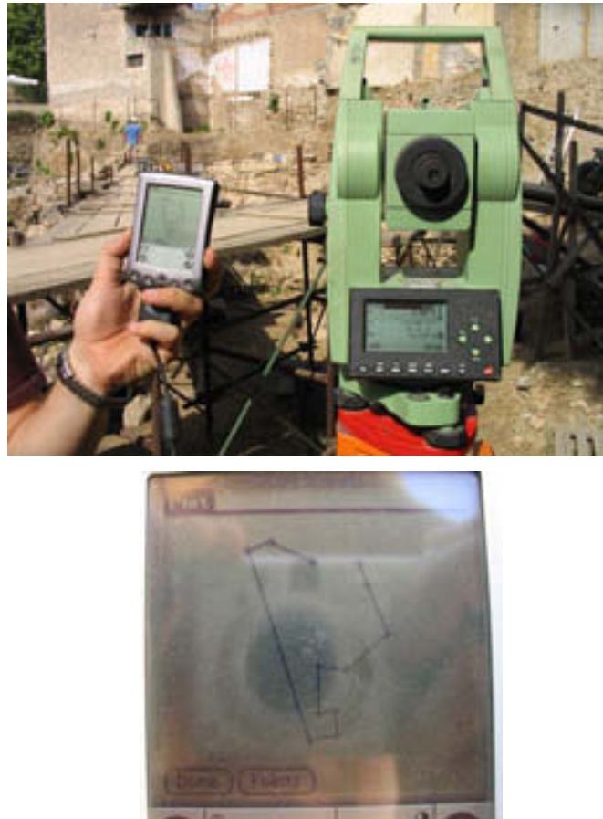
Εικόνα 6 - Σύνδεση θεοδολίχου με PDA και λεπτομέρεια της οθόνης γραφήματος (plot) αλληπάλληλων μετρήσεων (Bruce Haertzler, Αθήνα 2004)
