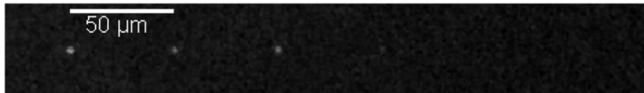
Σχήμα 5.5.α: Από αριστερά προς τα δεξιά διακρίνονται 4 spots (σε κατάσταση μέγιστου transmission) των 100, 60, 40, 25 pulses/spot για ενέργεια 0.3 \mu\text{J}/\text{pulse} . Το spot των 25 παλμών διακρίνεται οριακά.
