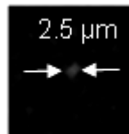
Σχήμα 5.6.α: Εικόνα σε μέγιστο transmission από spot του ενός “shot” ενέργειας 1.6 \mu\text{J}/\text{pulse} .
