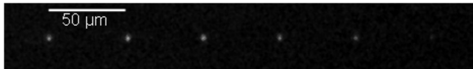
Σχήμα 5.5.β: Από αριστερά προς τα δεξιά διακρίνονται 6 spots (σε κατάσταση μέγιστου transmission) των 100, 60, 40, 25, 15, 5 pulses/spot για ενέργεια 0.4 \mu\text{J}/\text{pulse} . Το spot των 5 παλμών διακρίνεται οριακά.
