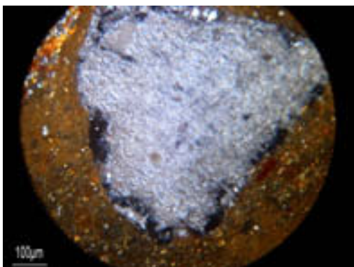
Εικόνα 51: Λεπτή τομή κεραμικής ύλης Α.1.β (Δείγμα Β1), ΧΡ, 250Χ: Λεπτομέρεια με έντονα κατακερματισμένες επιφάνειες στο χαλαζιακό υλικό και υψηλή περιεκτικότητα σε μαρμαρυγία
