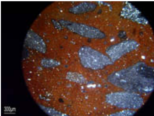
Εικόνα 61: Λεπτή τομή κεραμικής ύλης Α.4 (Δείγμα Ε764), ΧΡ, 63Χ
