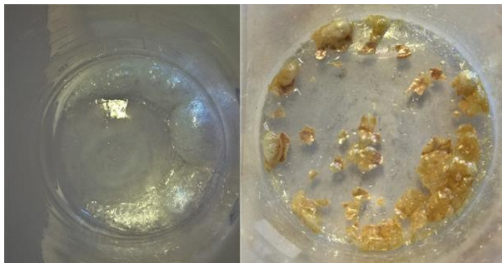
Σχήμα 18. Τυπικές φωτογραφίες του υλικού 5% Ce/ZrO_2 μετά την έψηση στους 100 °C υπό κενό (αριστερά) και μετά την έψηση στους 350 °C υπό οξυγόνο.
