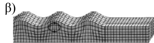
Σχήμα 3.2: Σχηματική αναπαράσταση των δυο ασύζευκτων κυμάτων στην επιφάνεια του υμενίου: α) κύματα Love β) κύματα Lamb
