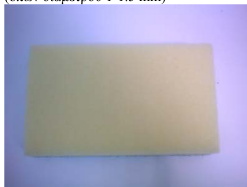
Φωτογραφία 17. Σπόγγος πλαστικός (οπών διαμέτρου 0.5 mm)
