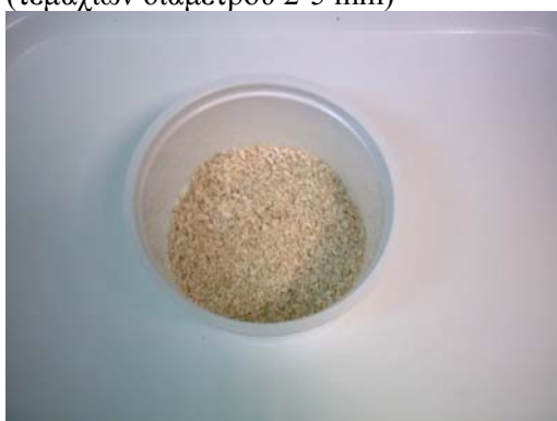
Φωτογραφία 5. Ροκά καλαμποκιού (τεμαχίων διαμέτρου 1-2 mm)
