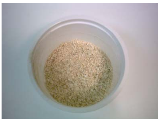
Φωτογραφία 4. Ροκά καλαμποκιού (τεμαχίων διαμέτρου 2-5 mm)
