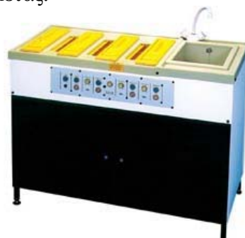
Σχήμα 4.5: Χημική επεξεργασία πλακέτας
