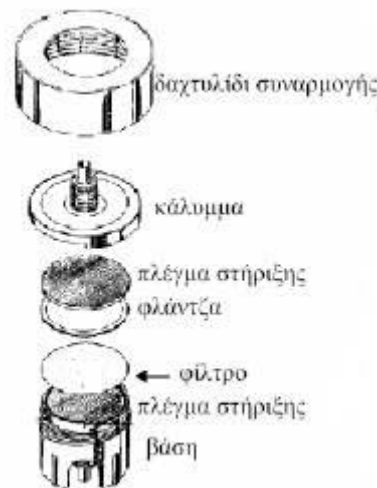
Εικόνα 13: Σχηματική αναπαράσταση δειγματολήπτη σωματιδιακής φάσης
