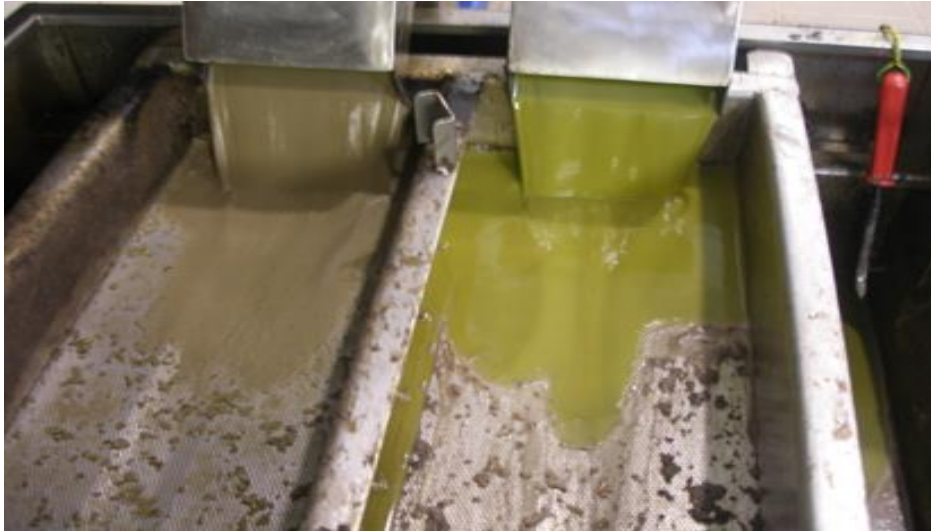
Εικόνα25: Παραλαβή ελαιολάδου με φυτικά υγρά και κασίγαρος από οριζόντιο διαχωριστήρα σε τριφασικό σύστημα ελαιοποίησης
