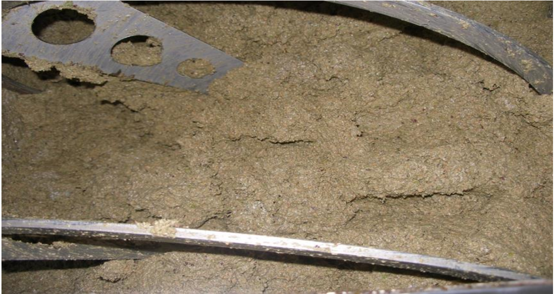
Εικόνα 24: Μάλαξη ελαιοζύμης τριφασικού συστήματος ελαιοποίησης
