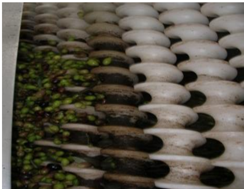
Εικόνα 15: Αποφυλλωτήριο σε διφασικό ελαιοτριβείο
