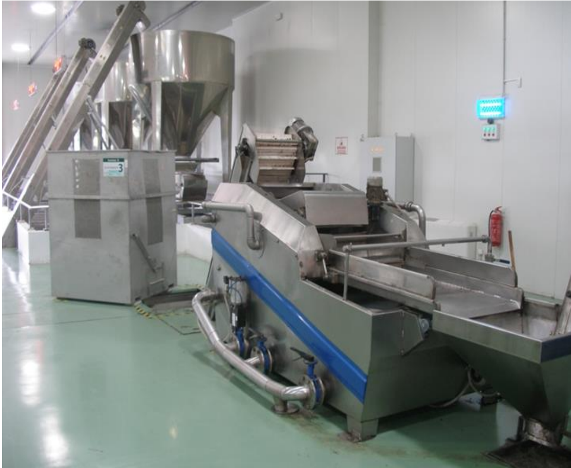
Εικόνα 14: Εσωτερικός χώρος στον οποίο διακρίνονται οι μονάδες παραγωγής και το σύστημα αποφύλλωσης και πλυσίματος του καρπού σε διφασικό ελαιοτριβείο
