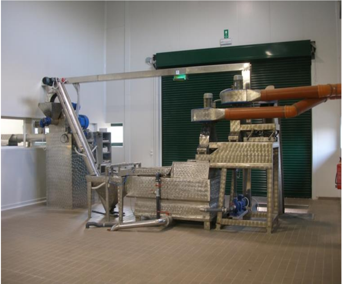
Εικόνα 23: Εσωτερικός χώρος τριφασικού ελαιοτριβείου πριν τη μάλαξη
