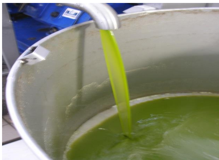
Εικόνα 26: Παραλαβή ελαιολάδου μετά τον κάθετο διαχωριστήρα σε τριφασικό ελαιοτριβείο
