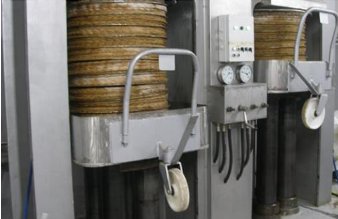
Εικόνα 12: Πρέσες υψηλής πίεσης για τον διαχωρισμό του ελαιολάδου με χαρακτηριστικά ελαιόπανα
