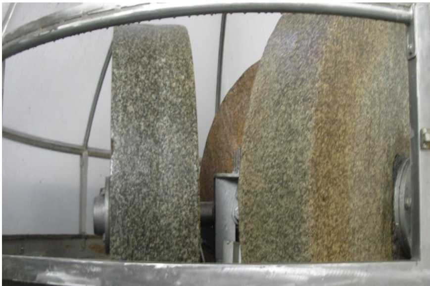
Εικόνα11: Μύλοπετρες ελαιοτριβείου παραδοσιακού τύπου με διαδικασία αυτοματοποιημένου ελέγχου.
