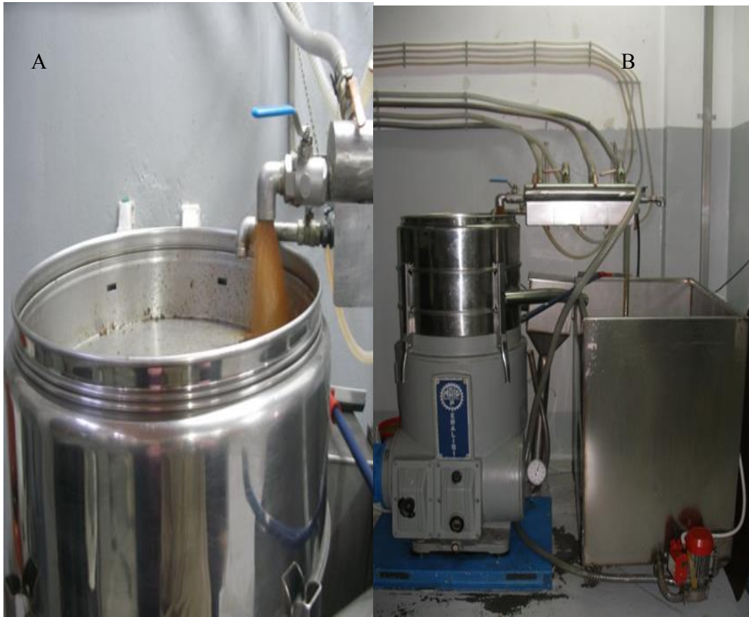
Εικόνα 13: Τελικός διαχωρισμός α) ελαιολάδου και β) κασίγαρου σε παραδοσιακό ελαιοτριβείο
